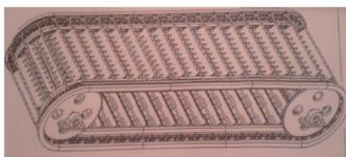
شکل ۸- نوار نقاله آکاردئونی (Sanabadi et al., 2014)
